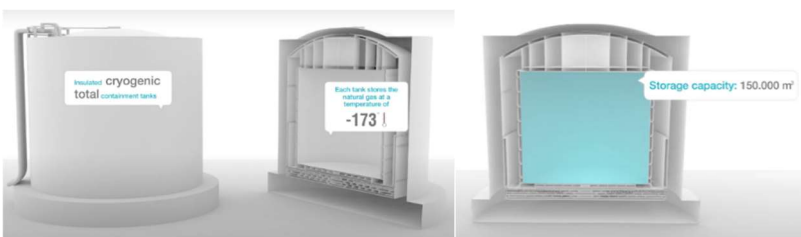
Detalle de los tanques de la Planta de Regasificación de El Musel (1)
